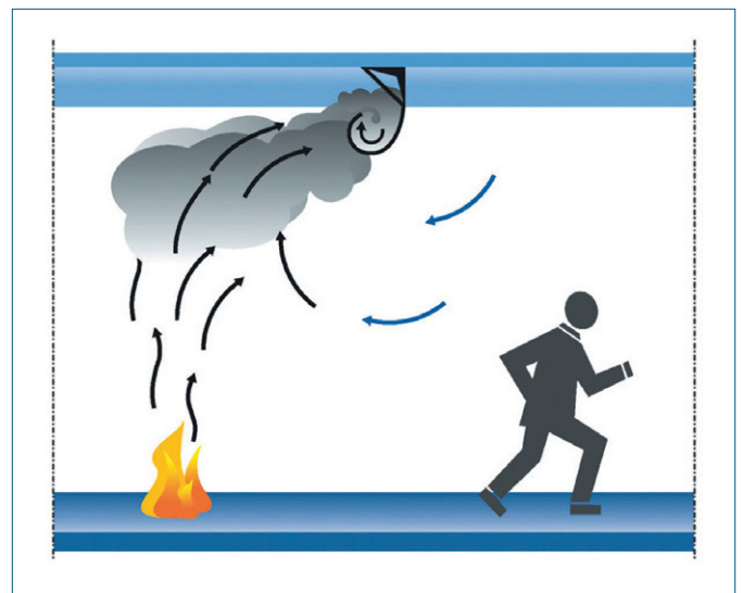
Bild 11: Virtuelle Rauchabschnittsbildung durch Drall- oder Wirbelhauben Quelle: TROX GmbH
